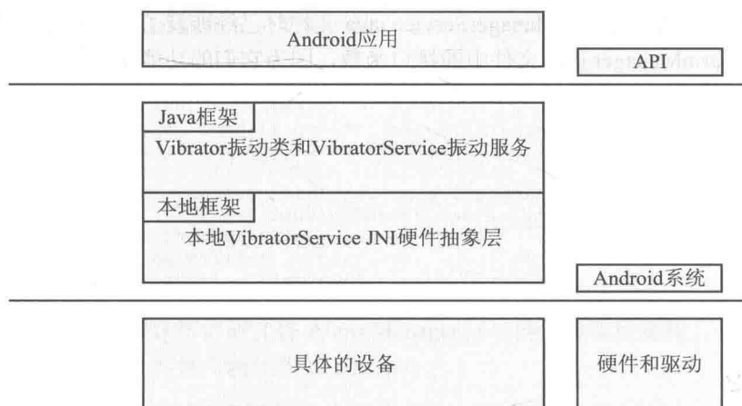
▲图 9-1 Android 振动器系统的基本层次结构
